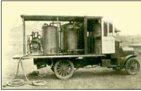
Mobiele W&T-drinkwaterbereider (de chloorcilinders zijn zichtbaar net achter de cabine).
